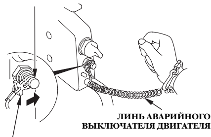
СКОБА АВАРИЙНОГО ВЫКЛЮЧАТЕЛЯ ДВИГАТЕЛЯ
