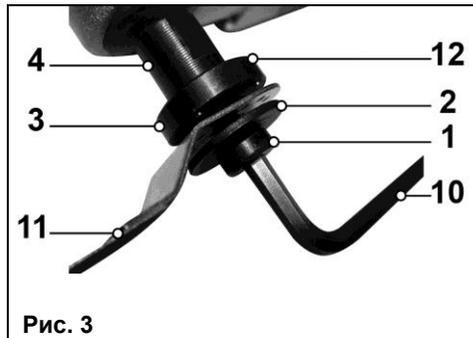
**Примечание:** Устанавливая насадку (11) убедитесь в том, что отверстия перфорации совпали с четырьмя установочными штифтами (12) на внутреннем фланце (3).
