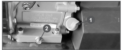
Рис.28 Замена моторного масла
