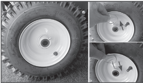
Рис.26 Установка шплинта на левом колесе
