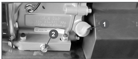
Рис.19 Замена моторного масла
