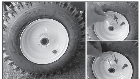
Рис.17 Установка шплинта на левом колесе
