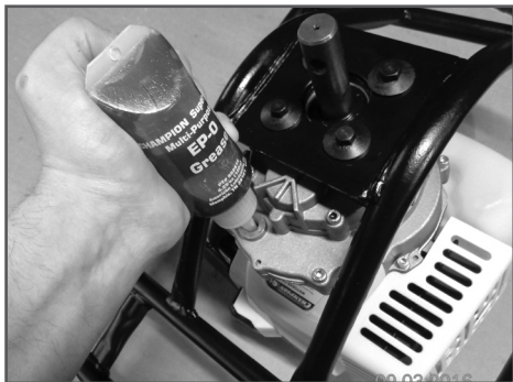
Рис. 15 Добавление смазки в корпус редуктора
