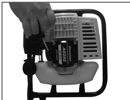
Рис. 7 Свободный ход шнура стартера
