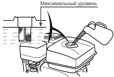
Рис. 5 Максимальный уровень топлива в топливном баке
