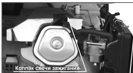
Рис. 14 Место расположения свечи зажигания
