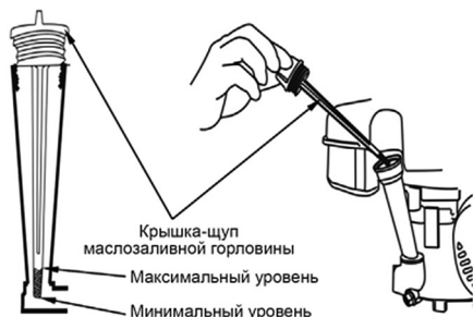
Рис. 7 Проверка уровня масла в картере
