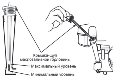
Рис. 9 Проверка уровня масла в картере
