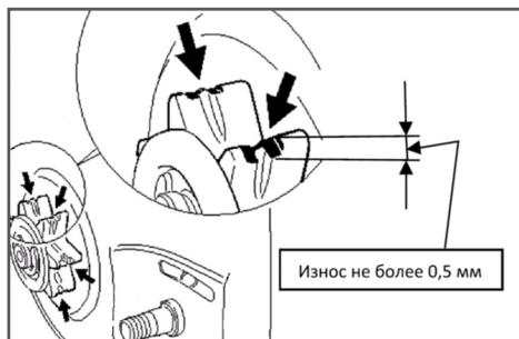
Рис. 16 Проверка износа звездочки
