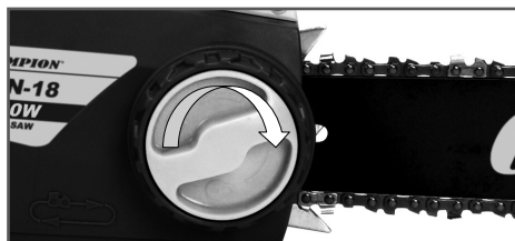
Рис. 6 Установка крышки шины
