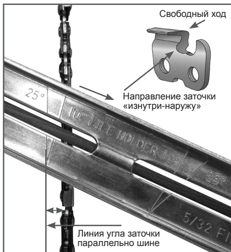
Рис.18 Определение угла заточки
