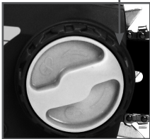
Рис. 7 Регулировка натяжения цепи
