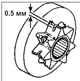
Рис. 27 Максимально допустимая глубина износа зубьев ведущей звездочки
