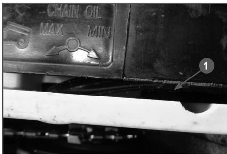
Рис. 8 Винт регулировки подачи масла
