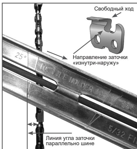
Рис. 22 Расположение линии угла заточки
