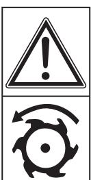
**ОПАСНО** – Не суйте руки и ноги к вращающимся частям машины. Держитесь на расстоянии от открытых отсеков во время работы машины. Острые части продолжают вращаться ещё некоторое время после остановки машины.
