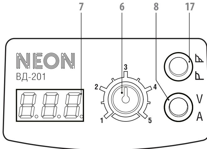
6 - Регулятор тока сварки; 7 - Трехразрядный цифровой индикатор; 8 - Переключатель режима индикации цифрового индикатора, 17 - Переключатель функции “**ARCFORCE**”
