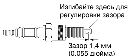
Рис. 12. Регулировка зазора свечи зажигания, нагреватель мощностью 10 кВт
